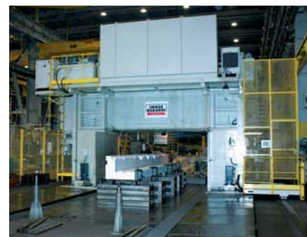
Вертикально-фрезерный станок Innse Berardi SpA с подвижным столом
