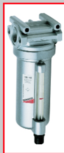
Рис. 3. Коалесцентный осушитель Camozzi. Присоединения G1/4, G3/8, G1/2, G1. Рабочая температура: от 0°C до +50°C. Фильтрация: 0,1/0,01 мкм
